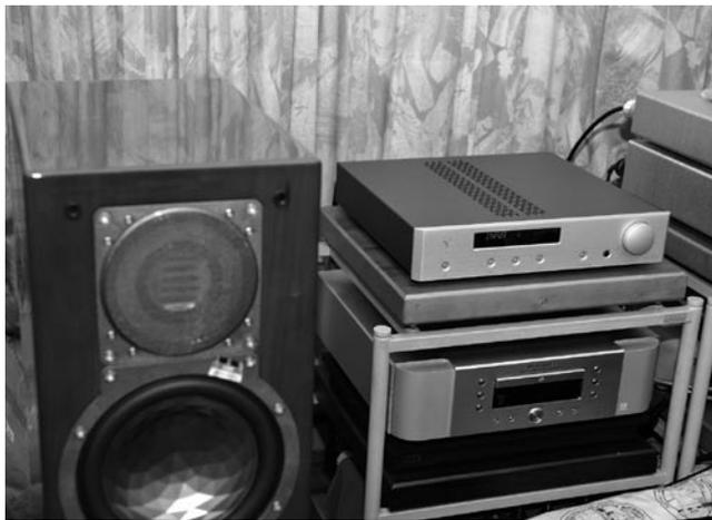
率管的上方，裝置了一個圓形迷你溫度監察器，作實時檢測工作中的驅動級溫度。Flight Three在8歐姆負載下，功率輸出是2x75瓦；4歐姆時則提升至2x130瓦。
