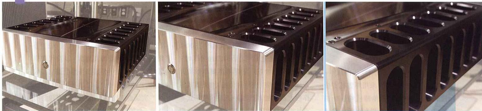
本线路设计、用料、布局与及结构方式，大致无异于同系中的两声道制作Model 625。其密闭式厚重扎实金属机箱，同是采用一件过最大型的铝合金金砖，并经历了精密计算机车床挖空而成，呈上下两个完全独立式架构的分隔部份，使得整个机箱具有更低的共振特性，并且有机箱的两侧，更同时附设了一列连体式的大型散热器，来驱走工作时产生的温度。从而可为内置上方的输入级与驱动级，以及下方装置开关式供电电路，提供一个绝对无缝，而且散热性能超卓，并具有高度稳定性能的工作平台。
