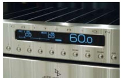
甚密，字體非常清晰悅目，Jeff 表示他們是首間採用如此新穎 VFD 的音響廠家。10 粒小按鍵一字排開，分別是 6 組訊源輸入的選擇，跟著是錄音，Menu，Standby 與啞音的按鍵，右邊一粒打磨得「立立令」的大型音量旋鈕兼負起確認菜單選項的責任。背板可簡約得多，只有一個用作軟件升級用途的 USB 連接埠，一個接駁遙控訊號接收器的插座與及左右聲道的直流電源輸出插座，
