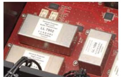
型較小的 Lundahl LL1588，變壓器的牛芯與外殼均採用具有高磁導系數和磁屏蔽功能的鎳鐵高導磁合金（mu metal）製造。兩個小艙則是連接輸入輸出端子線路板的所在地。至於發燒友最重視的音量控制，Jeff 表示 Criterion 的音量控制線路是廠方的最新設計，當用家扭動音量旋鈕或者按動遙控器的音量增減鍵，便會啟動內置的光電編碼器，透過微處理器對內置的 Burr Brown PGA2320 音量控制放大晶片發出指
