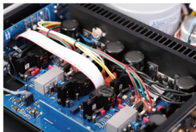
后级为真正的全平衡线路设计，极近的供电线路设计确保大电流输出的需求，并且拥有出色的速度响应
