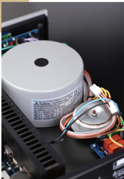
采用一大一小两只环形变压器供电，杜绝机内各线路间的串扰
