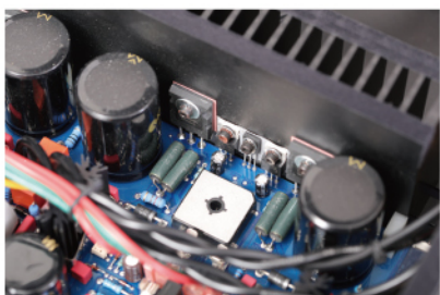
每声道使用一对双极功率放大晶体管，型号为 ON 安森美的 MJL3281A/MJL1302A，提供 2 \times 100 瓦 / 2 \times 160 瓦（8/4 欧姆）的驱动力
