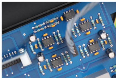
采用真正的前后级合并设计，保留了真正的前级电压增益线路
