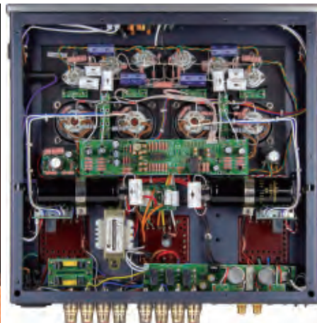
■ EVO 300 Power Amplifier后级的内部布局
