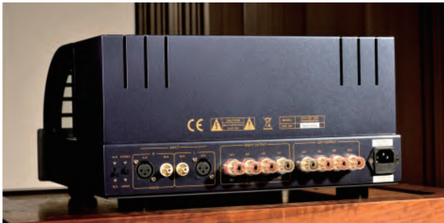
■ EVO 300 Power Amplifier后级的背部
