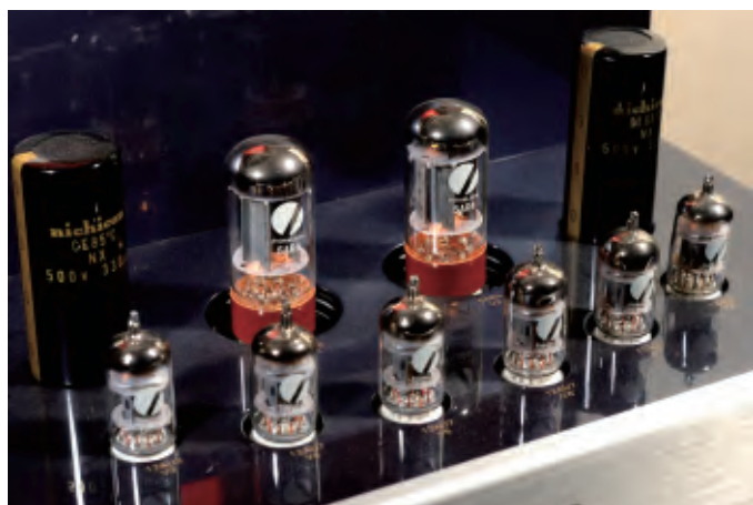
■ 每个声道采用了1只原厂生产的5AR4电子管进行整流，3只12AU7电子管作放大
