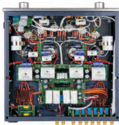
■ Evo 300 Preamplifier前级的内部布局
