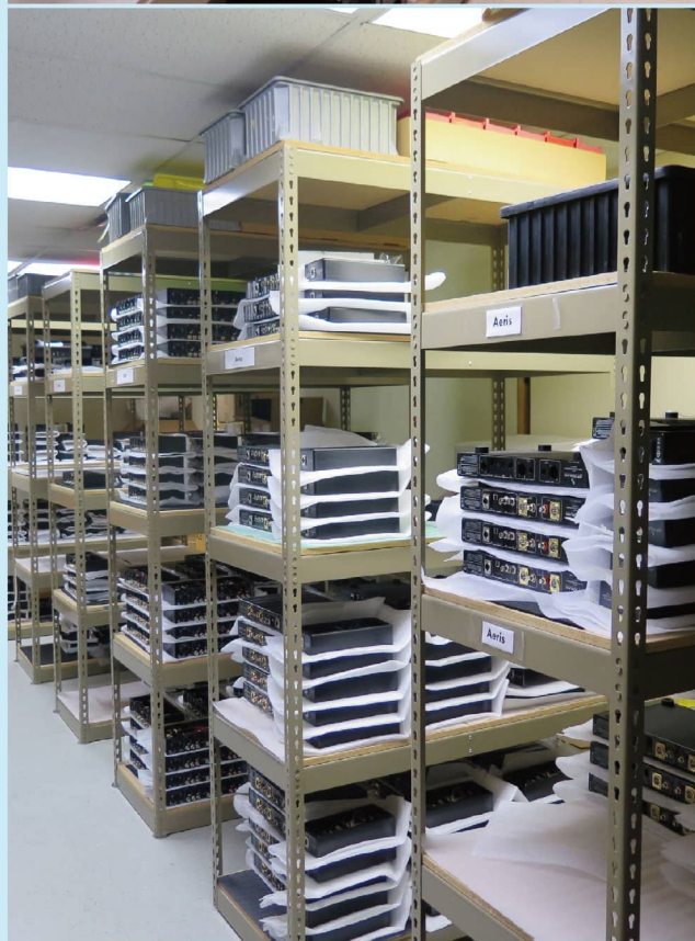
△當 JRDG 向美國最頂級的金屬加工廠 Vertec 訂購的漂亮機殼送回來之後，經過品檢便會裝嵌好大部份零件和設施，再存放在這裡等待最後安裝程序和測試。
