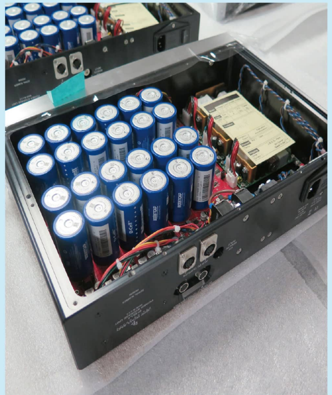
△這裡看見剛剛裝嵌完畢的新產品 PSU，可以為大部份 JRDG 的前端器材大幅改良電源供應，秘密武器在於那 24 支藍色大電芯模樣的 Super Cap，每支電容量為 3F (3,000,000 \mu F)，24 支的總電容量為 72F (72,000,000 \mu F)，有如此豐厚的電源供應打底，器材想衰聲都難！
