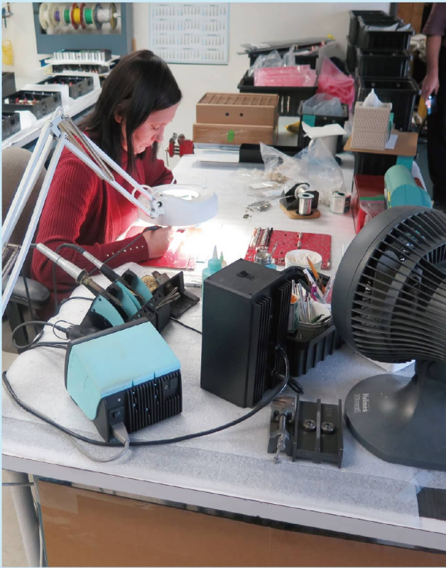
△這位女仕正在焊接線路板上的機內接線。
