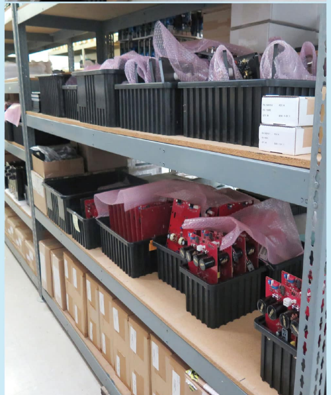
△JRDG 的器材都是採用在超高頻通訊與雷達領域使用的美國 Rogers 4 層線路板，當外發加工安裝好零件送回來之後，便會存放在這裡等候品檢和安裝。
