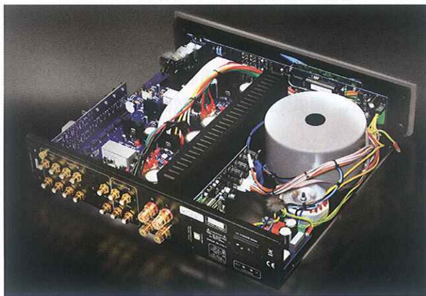
加大尺寸的机箱依然布局紧凑，可见用料不菲。机箱的 1/3 空间安置了一大一小两只环形电源变压器，避免了音频电路受到数字控制电源的回路干扰
