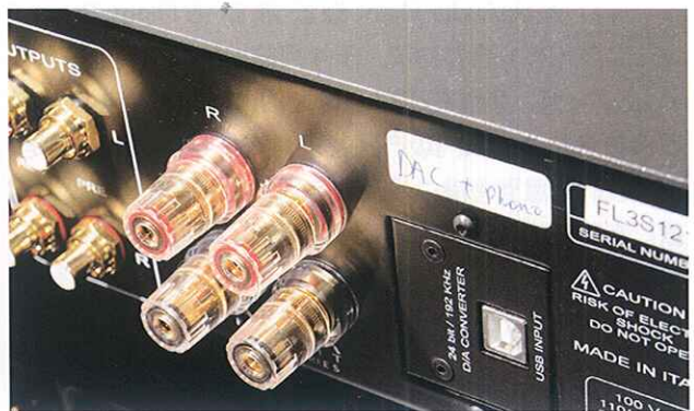
加装了 USB DAC 插卡，方便享受 24Bit/192kHz 数码流播放的高素质与便利
