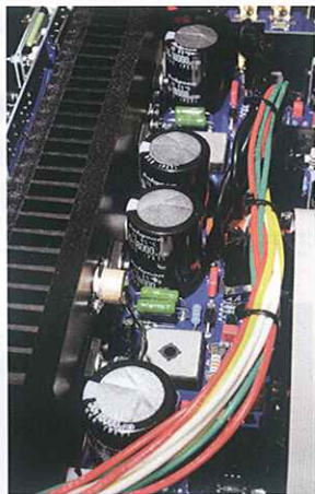
后级功率放大线路在功率管旁布置了 4 枚 50V18000 \mu F 电解电容（合共 72000 \mu F 电容）和整流桥堆，使电源储备能量充裕
