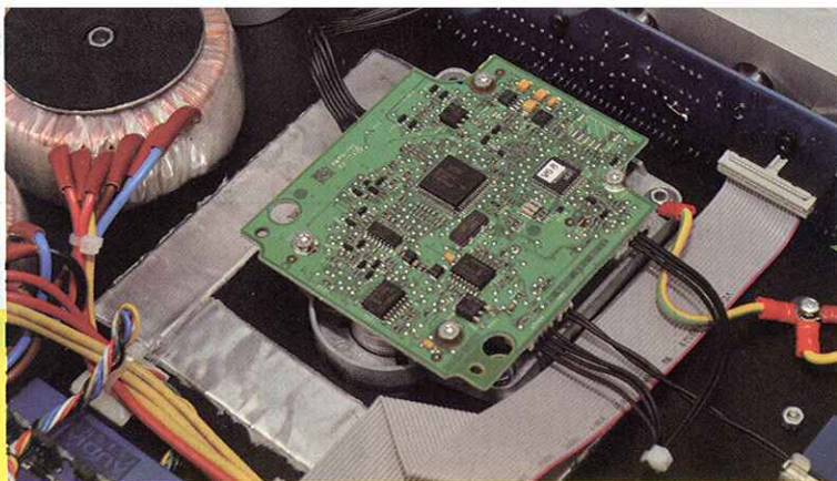
●轉盤的伺服線路設於底部。
